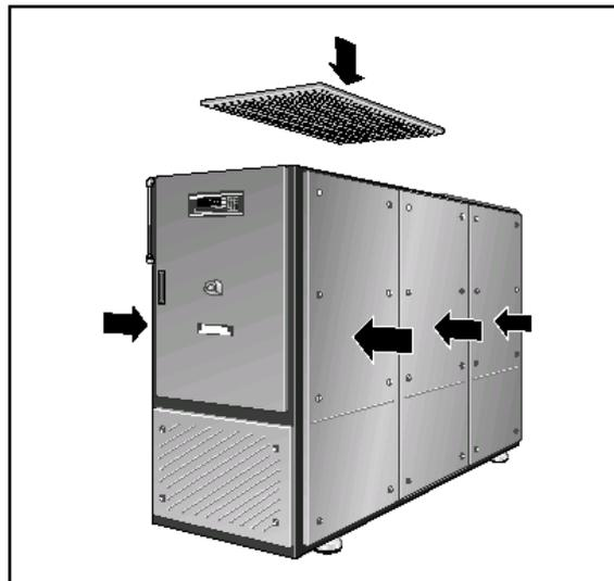
Fig. 14 Montare gli elementi della protezione insonorizzante
